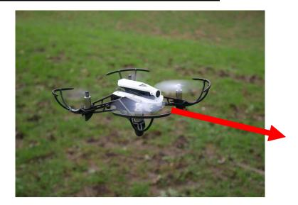
Eine Drohne kann man auf verschiedene Arten steuern. Einmal gibt es natürlich eine manuelle Fernsteuerung, mit der ein hoffentlich geschickter Pilot diese Drohne direkt steuert. Soll die Drohne jedoch weitere Strecken computergestützt zurücklegen, so überträgt ein Computer Steuerdaten an die Drohne. Diese lassen sich mit Vektoren darstellen. In unserem Fall überträgt der PC an die Drohne einen Vektor, der die Positionsveränderung der Drohne
